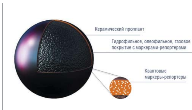
Рис. 1. Зерно маркированного проппанта с квантовыми маркерами-репортерами [1]
